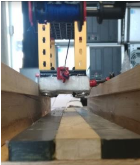
Imagen 16: Prototipo con poleas levitando
