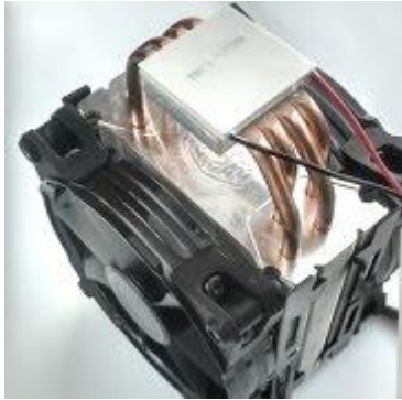
Fig.1 Refrigerador casero alimentado por celda peltier
