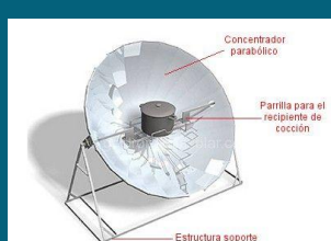
Fig. 3 Cocina solar parabólica.
